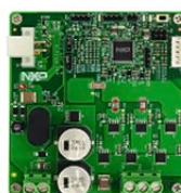
S12ZVM-EFP 電動燃料ポンプ 12ZVML128 リファレンス・デザイン
