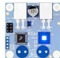
S12ZVL32-LED LINを使用したRGB LED照明 S12ZVL32 リファレンス・デザイン
