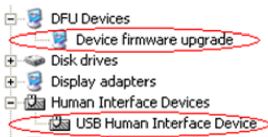
图 14. 设备管理器中的 DFU 设备和人机接口设备
